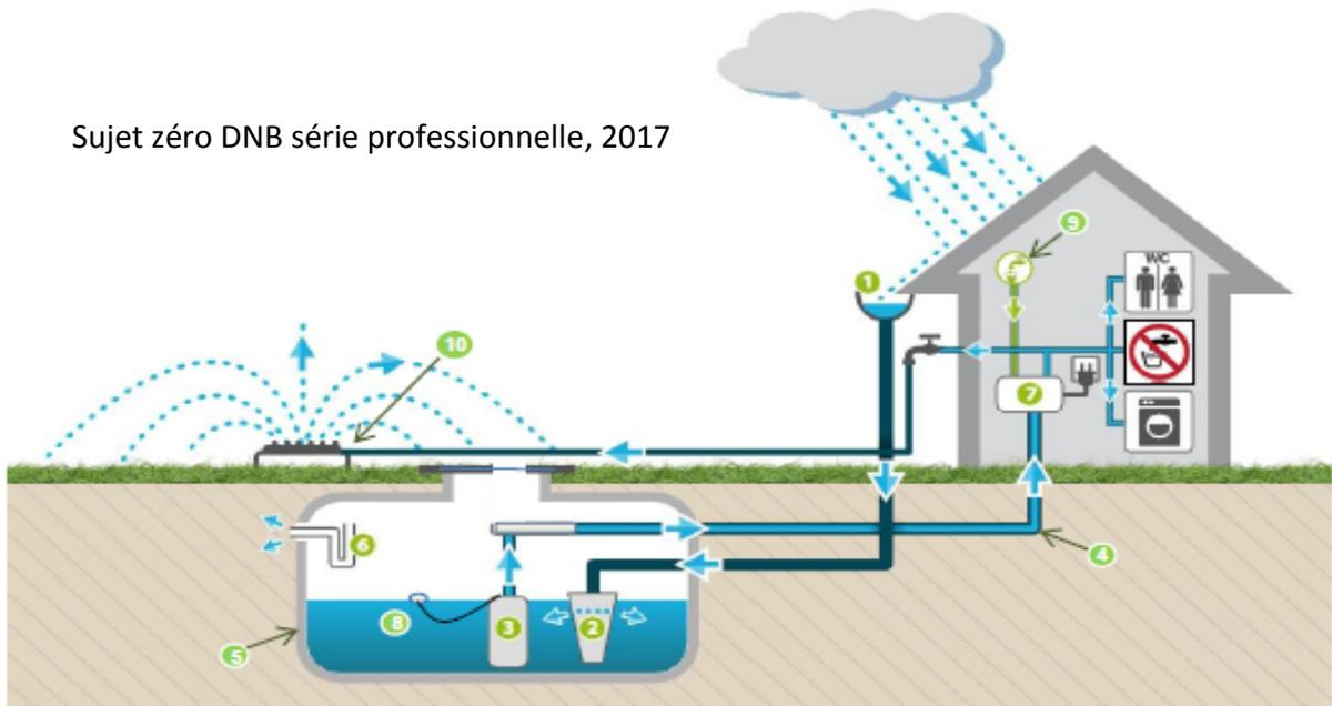
Figure 1 : Installation technique de récupération et de distribution d'eau de pluie.
