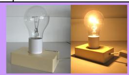
La lampe à incandescence traditionnelle, a été inventée en 1879 par Joseph Swan et améliorée par les travaux de Thomas Edison. Le filament conducteur est porté à haute température par le passage d'un courant électrique, il émet alors de la lumière. Le rôle de ce convertisseur d'énergie est de transformer l'énergie électrique en énergie radiative et thermique.
