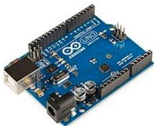
ARDUINO est une carte électronique qui comporte un microcontrôleur, c'est-à-dire une carte électronique programmable par un ordinateur. Elle utilise un même logiciel de programmation (environnement de développement ou IDE) appelé également Logiciel Arduino. Le langage de programmation est du C++ mais il est possible d'utiliser un langage par blocs comme Scratch pour travailler avec les élèves.
