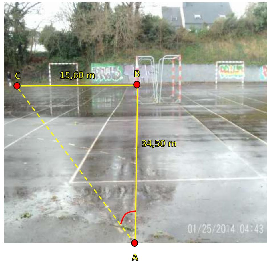
Calcul du demi angle d'ouverture :  $\text{Arctan} \left( \frac{BC}{AB} \right) = \hat{A} = 24,3^\circ$
